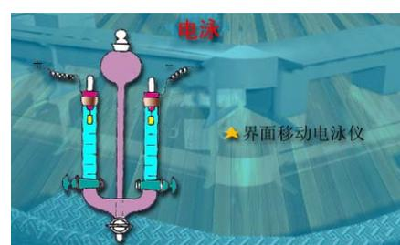
小心打开活塞，接通电源，观察液面的变化。若是无色溶胶，必须用紫外吸收等光学方法读出液面的变化。
